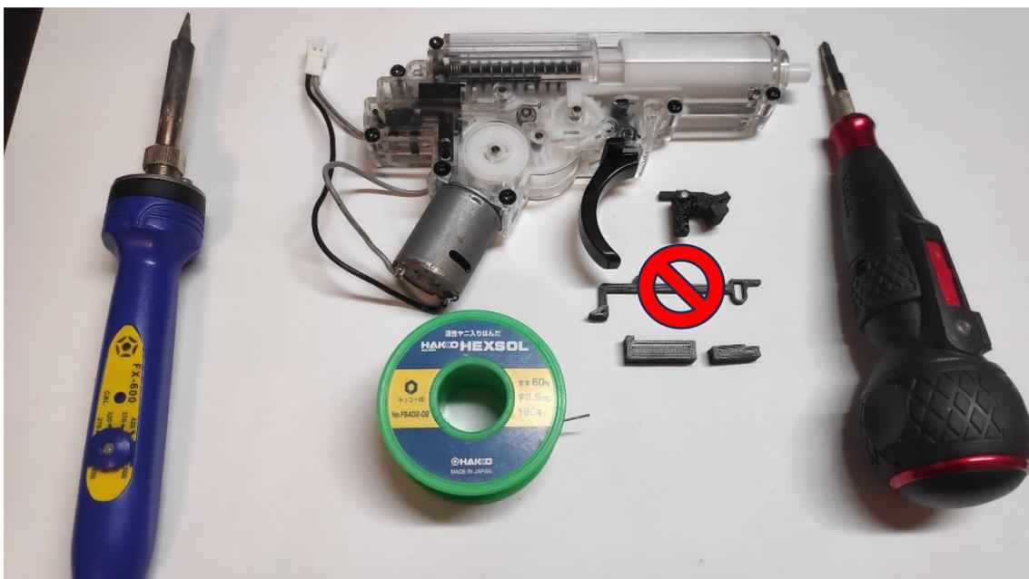
・ドライバー(プラス No.1、星形 T10)、メカボックス本体、IZANAMI 本体、IZANAMI 周辺パーツ、半田線、半田ごてを用意します。
