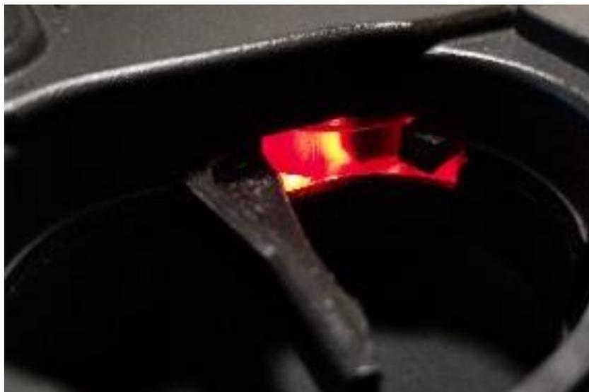
IZANAMI Lite は赤 LED の点滅で状態を表示します。
